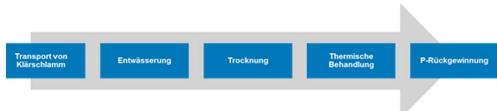
Bild 10: Die für die Treibhausgas- Betrachtung der P- Rückgewinnung herangezogenen Prozessschritte
