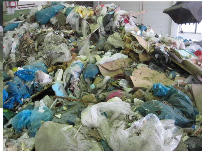
b) Beispiel für geringe Wertstoffqualität: hoher Anteil verschmutzter und feuchter Wertstoffe
