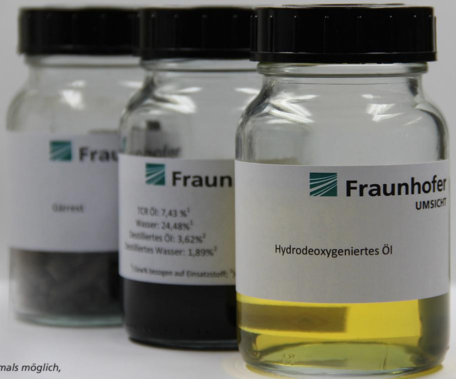
*Mit den Ölen aus der TCR®-Technologie ist es erstmals möglich, Kraftstoffe für Fahrzeuge aus biogenen Reststoffen (z.B. Gärrest) zu gewinnen.*
